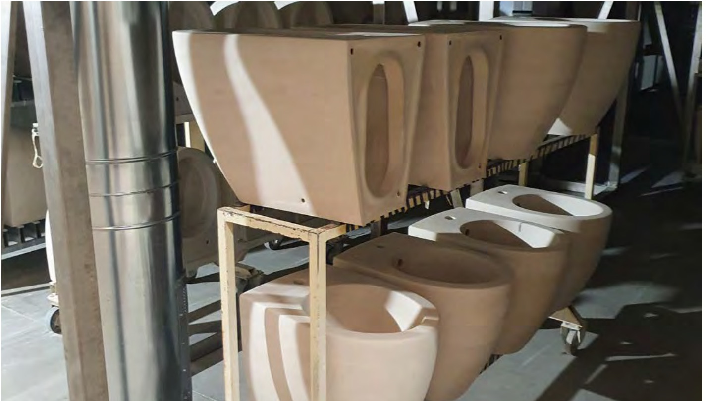
Drying in the the new Rapid Dry dryer ~ Essiccamento nel nuovo essiccatoio Rapid Dry
